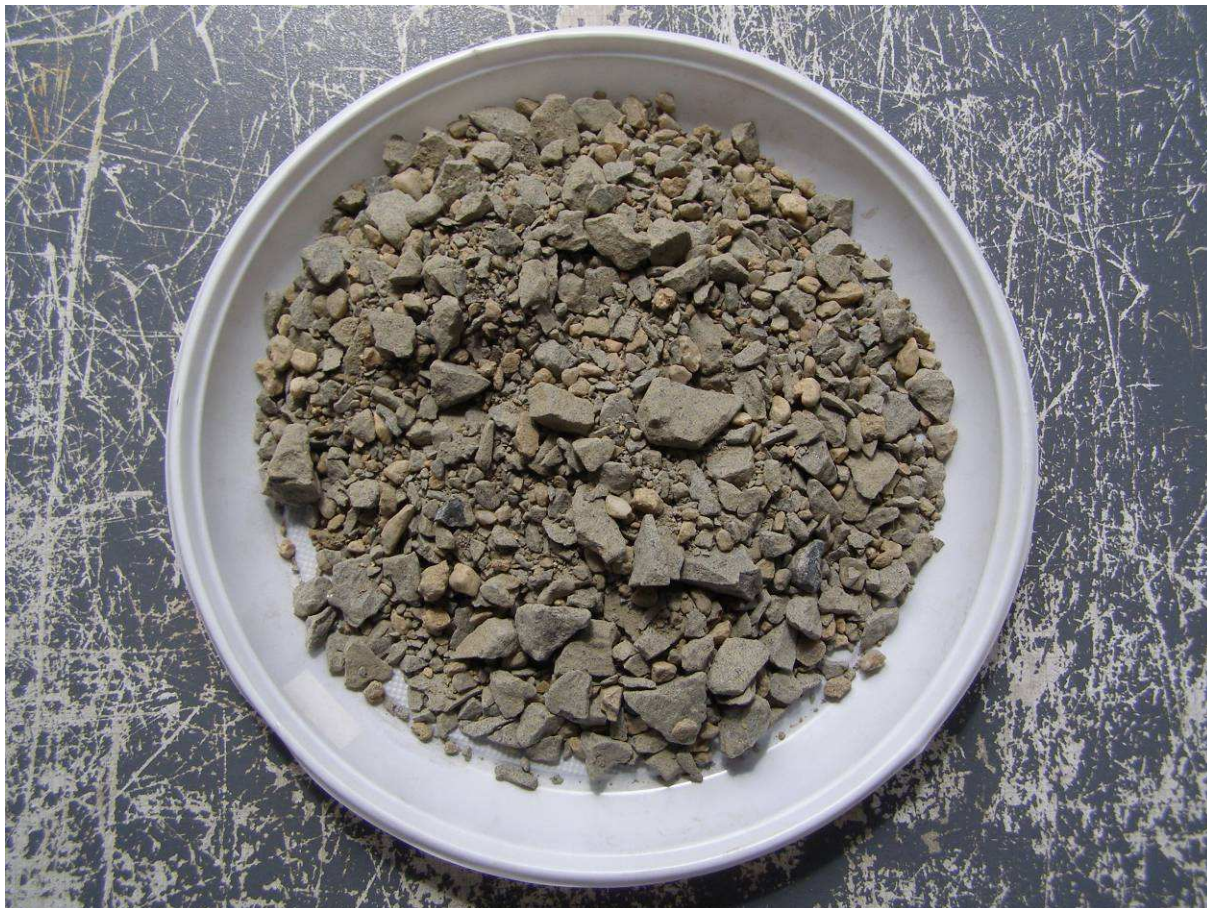
Fot. 3. BERGOLIT G (Baustoffe GmbH – BERGOLIT G 0/16, nach DIN 18035 Teli 5)
