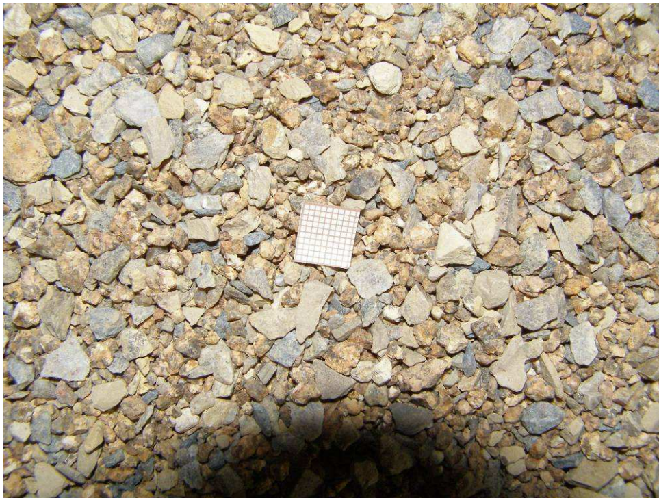
Fot. 8. Główne skały nawierzchni drogowej PLAZADUR 0/8
