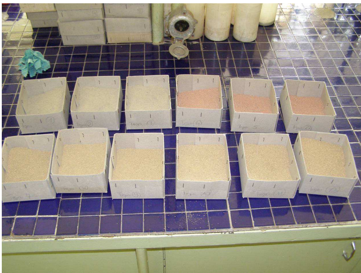
Fot. 2. Próbki frakcji mniejszej od 1 mm poddane badaniom chemicznym
