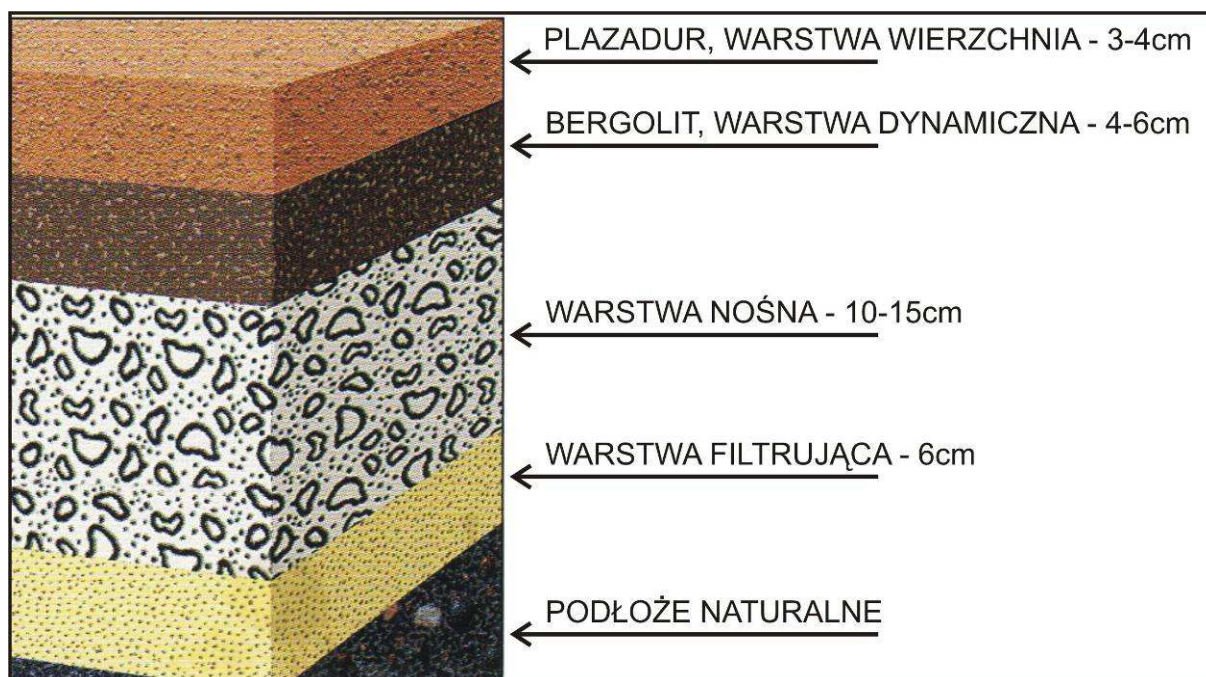
Rys. 1. Przekrój nawierzchni tegra (wg zaleceń producenta)
