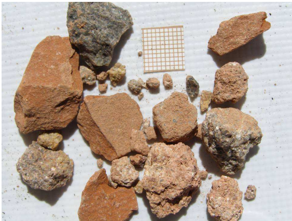
Fot. 6. Główne skały i tłużeń ceglany nawierzchni drogowej BERGOLIT Z
