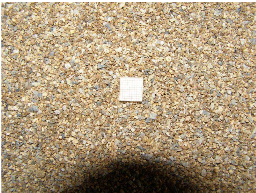
Fot. 10. Główne skały nawierzchni drogowej PLAZADUR 0/5
