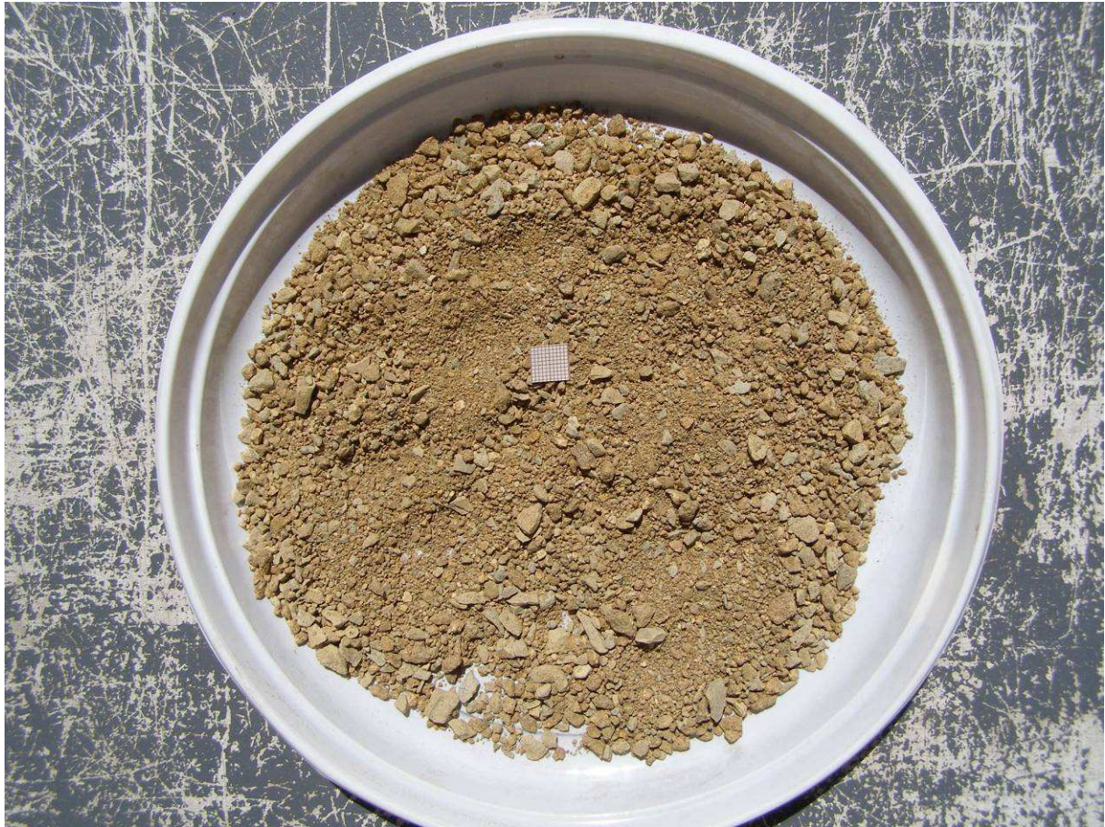
Fot. 9. PLAZADUR 0/5 ( Baustoffe GmbH – Wegedeckschicht 0/5, PLAZADUR gelbbeige N )
