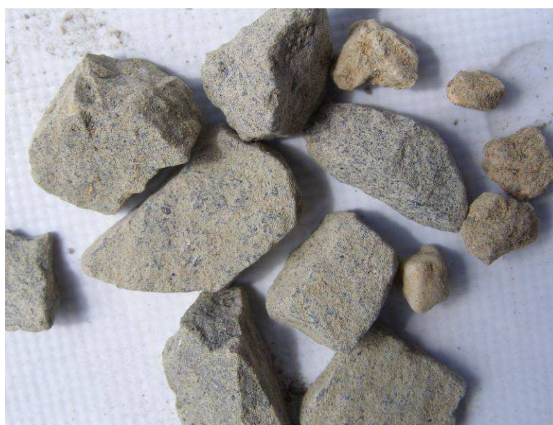
Fot. 4. Główne skały nawierzchni drogowej BERGOLIT G
