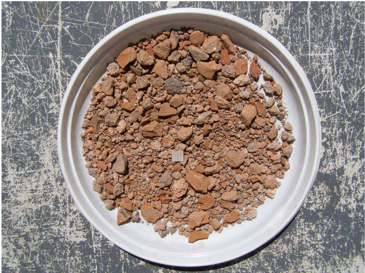
Fot. 5. BERGOLIT Z ( Baustoffe GmbH – BERGOLIT Z m 0/16, nach DIN 18035 Teli 5 )
