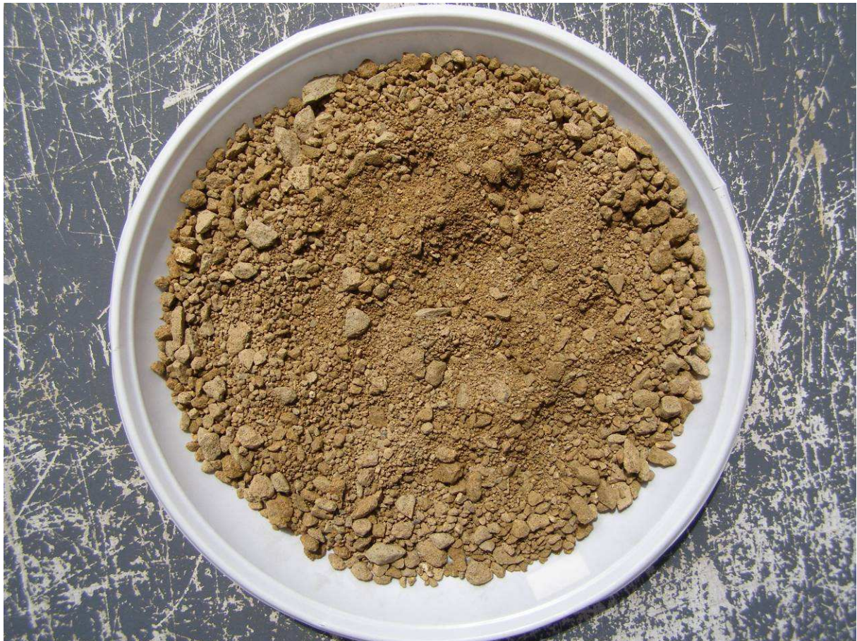
Fot. 7. PLAZADUR 0/8 (Baustoffe GmbH – Wegedeckschicht 0/8, PLAZADUR gelbbeige N)
